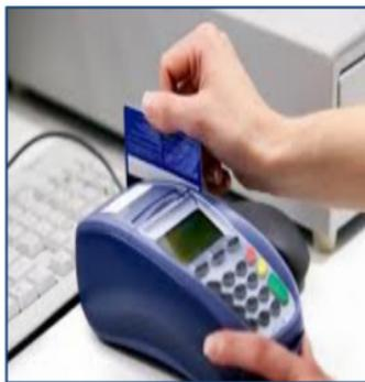
magnetis kartu (*card's magnetic stripe*) atau *chip*, tombol menu dan angka untuk memasukkan jenis transaksi, nilai transaksi, dan PIN, layar untuk melihat jenis dan nilai transaksi, dan printer untuk mencetak bukti transaksi.
